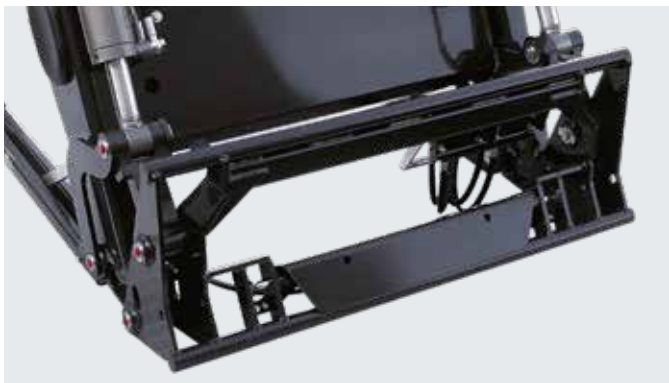
Zapah priključka s pritiskom na gumb, še udobnejša menjava priključkov, ne da bi vam bilo treba zapustiti voznikov sedež – s funkcijo HYDRO-LOCK.
